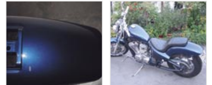
Cleane Optik? Der Wunsch nach Beseitigung von serienmäßigen Halterungen im Kunststoff (hier der Rücklicht-Sitz im Schutzblech) ist nicht selten. Bei Plastec schweißt man so was einfach zu. Spachteln-nein danke.
