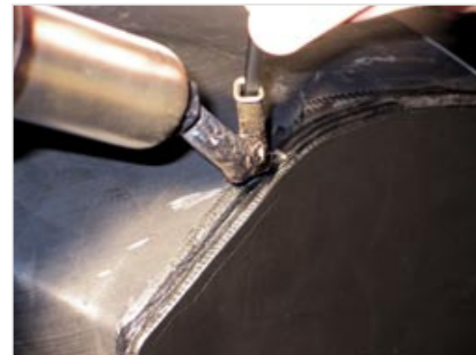
Auch umfangreichere Modifikationen sind kein Problem. Im vorher/nachher-Bilderquartett oben ist der Verlauf einer Totaloperation am Monocoque-Unterbau einer Voxan dargestellt. Saubere Sache, der Patient ist absolut dicht.
