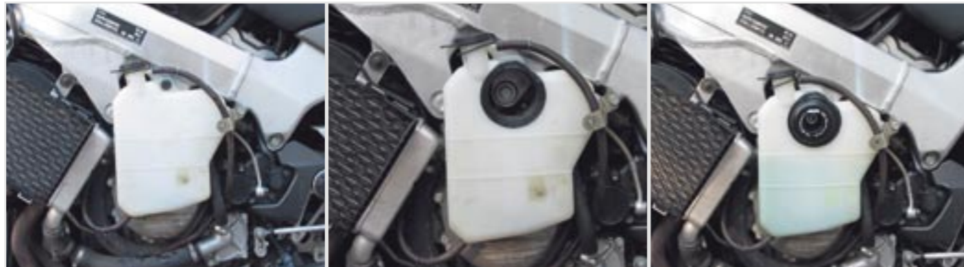
Auch möglich: Funktionale Modifikationen. In diesem Beispiel stand der Ausgleichsbehälter des Kühlkreislaufs einer zweckmäßigen Sturzpad-Montage im Weg - fachgerechter „Tunnel-Einbau“ Made by Plastec als pragmatische Lösung.
